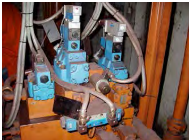
Slika 3 : Eden od številnih ventilskih blokov hidravličnega sistema (HS) – postrojenje Steckel v vroči valjarni, SIJ Acroni
