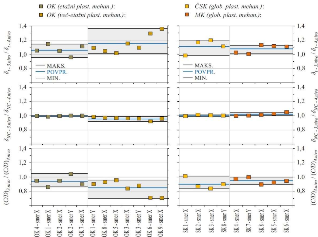
Slika 5.34: Primerjava potresnih zahtev in kapacitete konstrukcije v obliki etažnih zamikov \delta_i , \delta_{NC} ter ocene potresne odpornosti C/D = \delta_{NC} / \delta_i na tretjem in četrtem nivoju računa.
