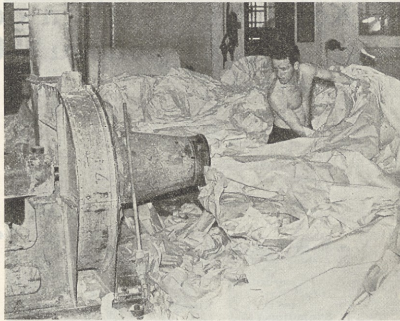
Ko se papirni trak na stroju utrga, hitro nastane precejšen kup izmeta, ki ga je treba čimprej spraviti do predelovalnice. V pomoč je pihalna naprava
