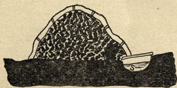
Sl. 50. Taljenje onečiščenega žvepla. Potrebna toplota nastaja z gorenjem enega dela žvepla.
