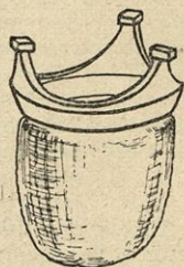
Sl. 87. Obrnjena Auerjeva mrežica za invertirno svetlobo.
