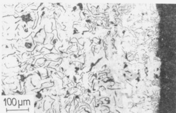
Slika 6: Mikrostruktura z RB 25 cepljene litine (palica s premerom 30 mm); trajanje odstajanja po cepljenju: 7 minut
