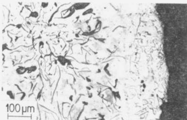
Slika 5: Mikrostruktura z RB 25 cepljene litine (palica s premerom 30 mm); trajanje odstajanja po cepljenju: 2 minuti
