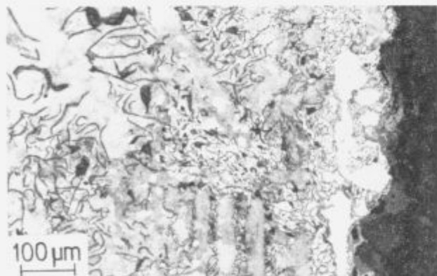
Slika 4: Mikrostruktura necepljene litine (palica s premerom 30 mm); stopnja nasičenja SC = 1.0
