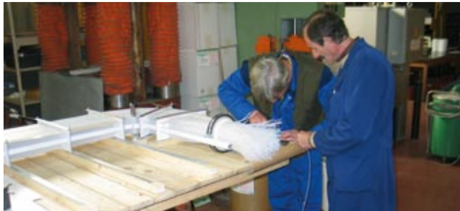
Pri izdelavi cevnega paketnega izmenjevalca v Veflonu
