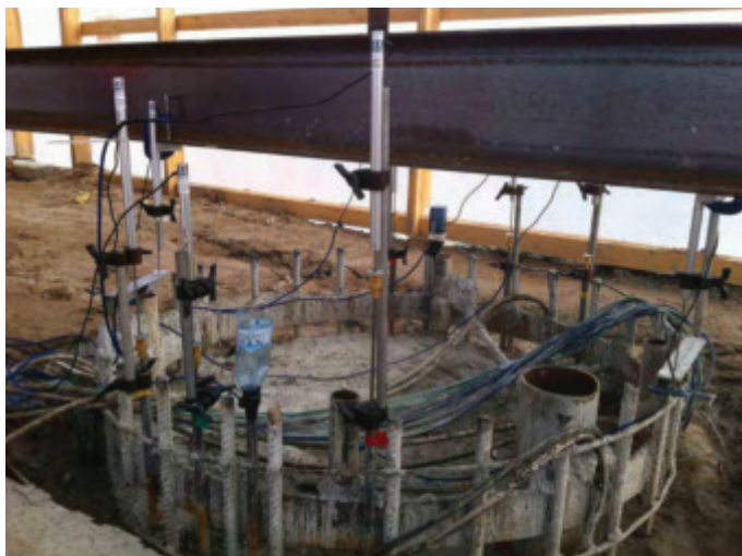
Slika 10 • Testni pilot Osterberg Cell.
