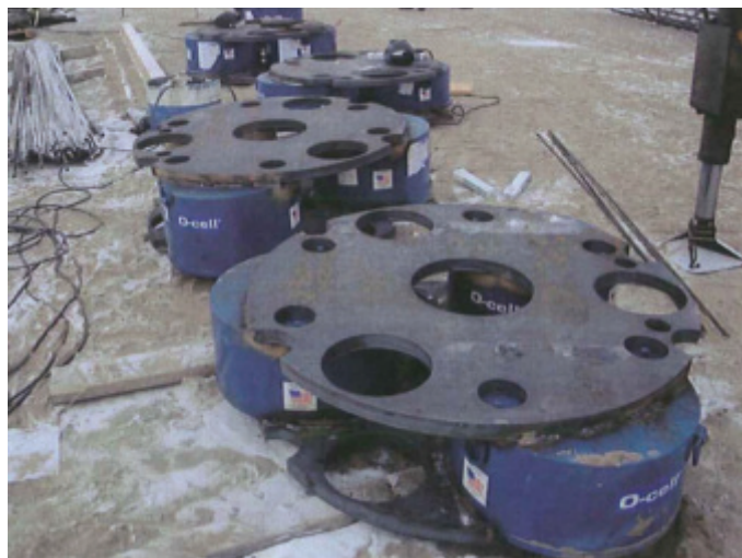
Slika 11 • Test dvigalke Osterberg Cell.
