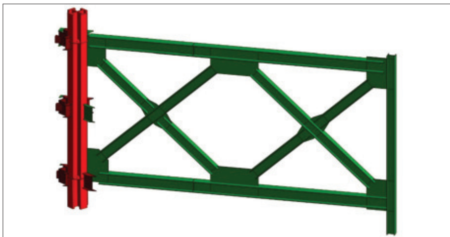
Slika 27 • Jekleno paličje v prečnih.
