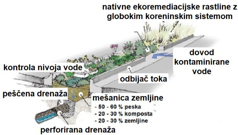
Slika 154: Umetno mokrišče za čiščenje vode s cestišč Vir: Fito Benefit 2015, prosojnica 20
