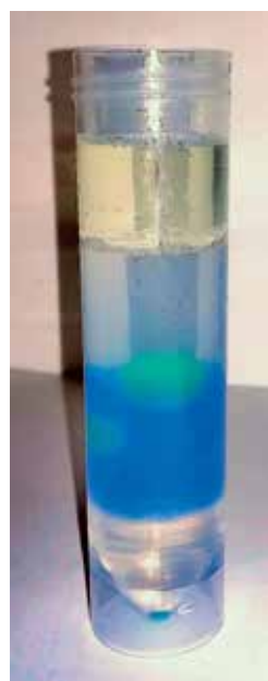
Slika 8: Tekočinski stolpec iz glicerina, detergenta, vode in olja. V njem so tri kroglice hidrogela različnih premerov, najmanjša je na dnu glicerinske plasti, srednja v plasti detergenta in največja na meji plasti detergenta in vode.
