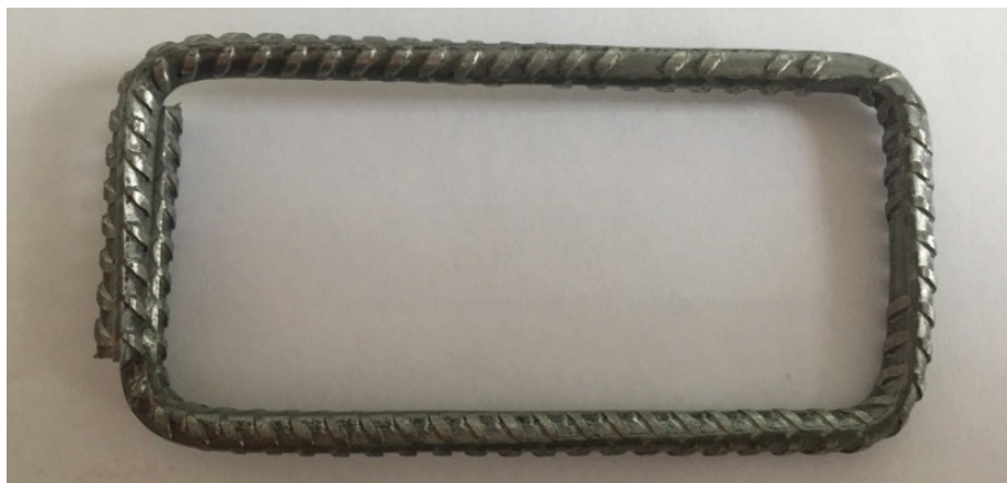
Slika 6 • Zaprto streme iz rebroste armature \phi 5 mm.
