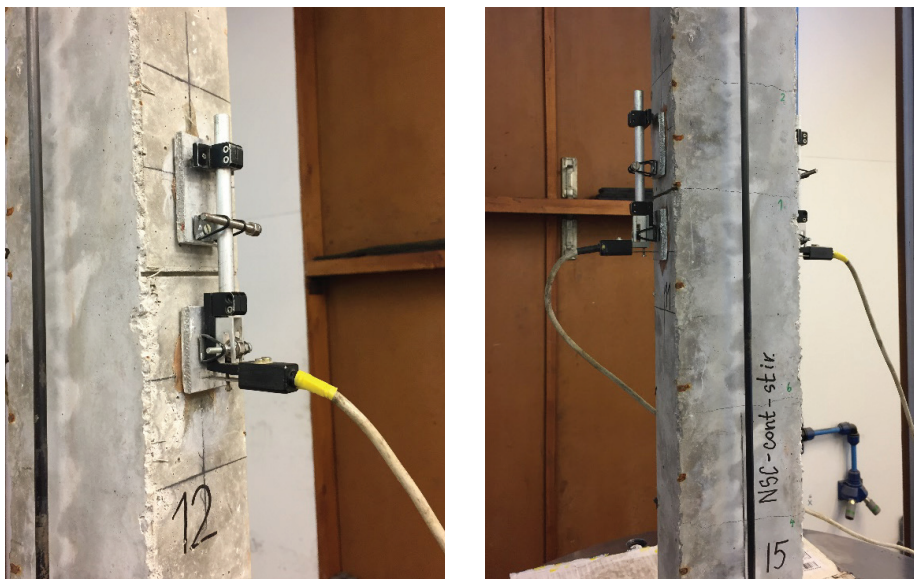
Slika 11 • Položaj deformetra 12 (leva slika) in 15 (desna slika) pri preizkušancu s kontinuirno palico.
