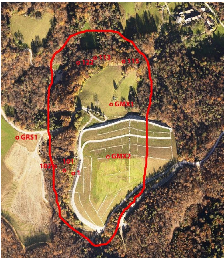
Slika 75: Obseg plazu na območju Boršta, mesta opazovanih točk GPS nadzora (V-GPS ob GRS1, III-GPS ob GMX1 in II-GPS ob GMX2) in geodetske mreže (točke 113, 115, 122, 1, 101, 102)
