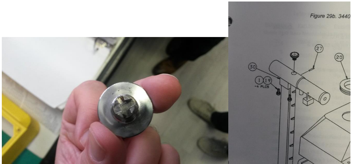
Slika 102: Shema ročice in držala z varnostnim vijakom na vrhu (desno), zlomljeno pero varnostnega vijaka (Foto: ZVD d. o. o.)
