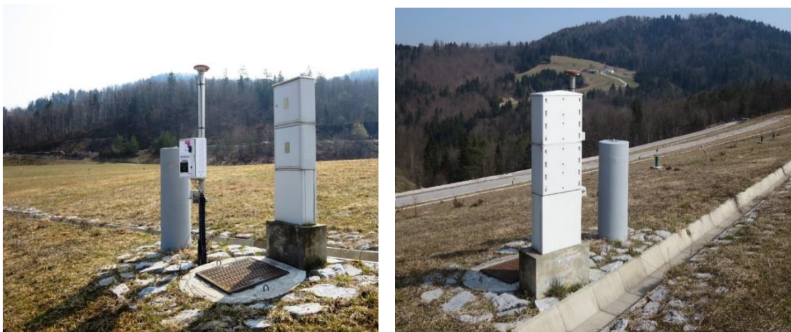
Slika 83: Opazovalna točka GPS nadzora stabilnosti območja odlagališča Boršt II-GPS ob permanentni GNSS postaji GMX2 na zgornji etaži odlagališča (foto: RŽV)
