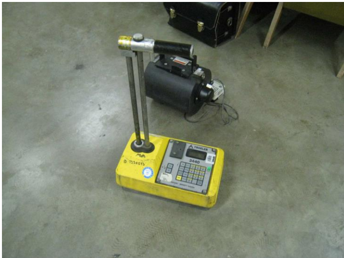
Slika 104: Sonda TROXLER 3440, pri kateri je prišlo do okvare pomičnega mehanizma (Foto: ZVD d. o. o.)
