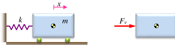
Slika 3.10: Model za nedušeno lastno nihanje in zunanje sile v smeri x
