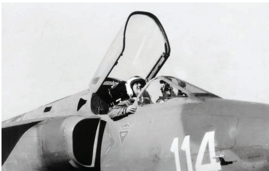
Orel 25114 s pilotom in dvignjenim pokrovom kabine. Zasteklitev se je pri enosedežnih letalih odpirala navzgor. Romuni so zaradi težav z mehanizmom zapiranja kabine te v poznejših serijah priredili tako, da so se odpirale v desno, kot je to tudi v primeru vulturja v Parku vojaške zgodovine v Pivki. Letalo 25144 je bilo na letališču Cerklje ob Krki od leta 1985 in vse do 1991, dokler so bili orli v Sloveniji. (Foto arhiv Cvetka Daničiča, posredoval Marko Malec)
