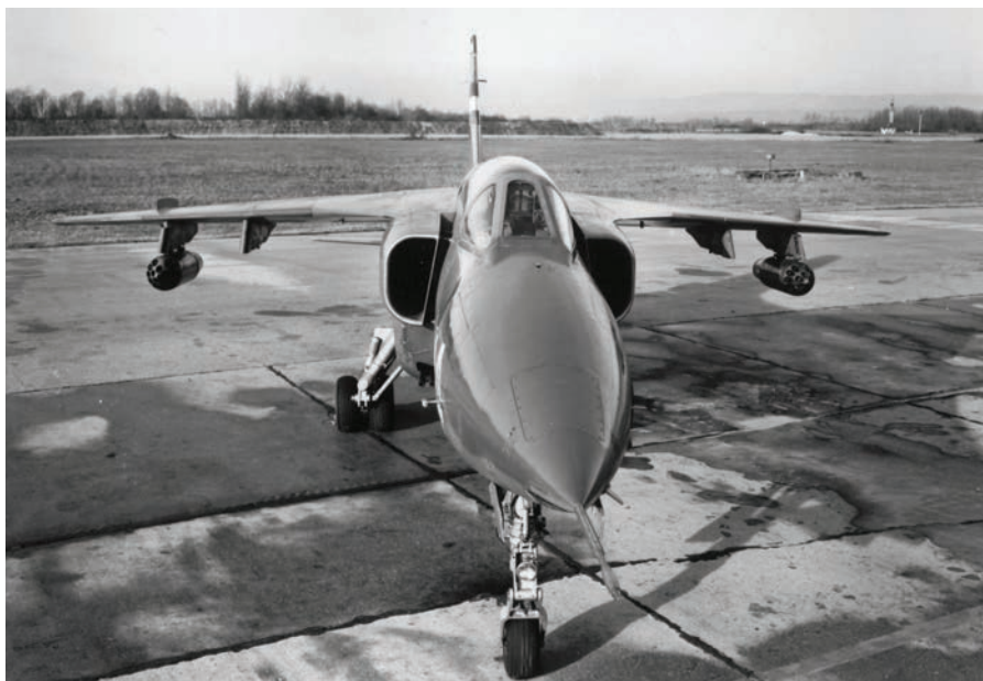
Pogled na orla J-22 s številko 25114 s sprednje strani. Na nosu letala so v redni serijski proizvodnji v mostarskem Soku odstranili tako imenovane »brke«, kot so rekli ozkim stabilizacijskim površinam na nosu letala. Letalo je oboroženo z raketnimi lanserji z nevodnimi raketami 57 mm. (Foto: arhiv Borisa Krautblata)
