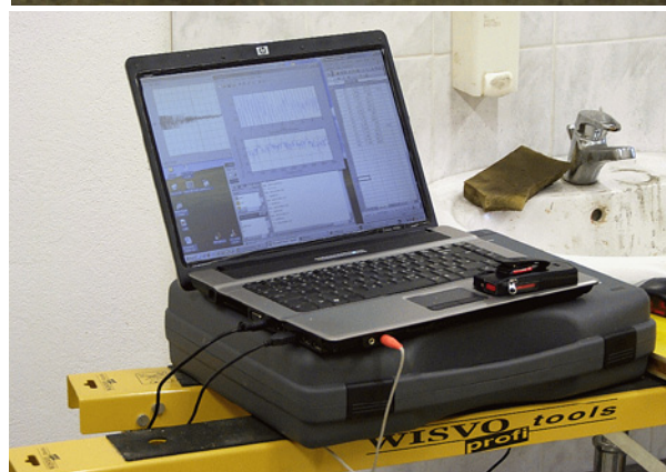
Slika 2. Določanje frekvenčnega modula elastičnosti (foto: arhiv ZAG)
