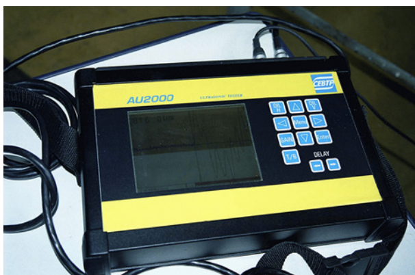
Slika 3. Določanje ultrazvočnega modula elastičnosti (foto: arhiv ZAG)
