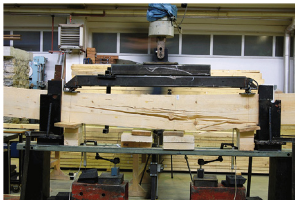
Slika 6. Detajl porušitve (foto: arhiv ZAG)
