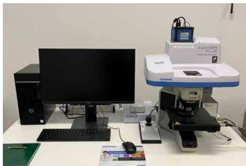
Slika 1 : Ramanski spektrometer z optičnim mikroskopom z visoko prostorsko in spektralno ločljivostjo (foto: Laboratorij za tribologijo in površinsko nanotehnologijo)
