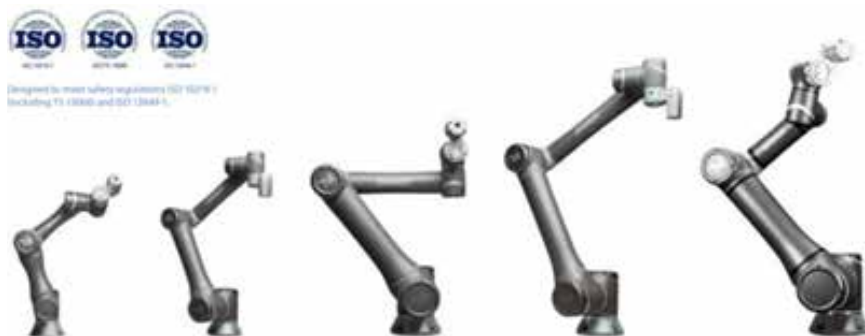
Slika 1: Sodelujoči roboti OMRON (TM5, TM14, TM12 in TM16) z nosilnostjo od 6 kg do 16 kg in dosegom med 700 in 1300 mm
