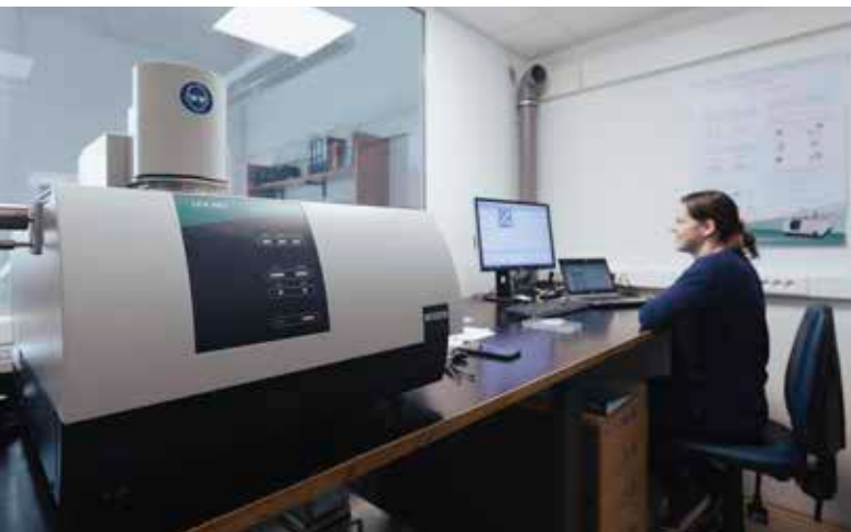
Slika 2 : Modularni sistem za karakterizacijo izotropnih in anizotropnih termičnih lastnosti aplikativnih multifunkcionalnih materialov (foto: IFP, d. o. o.)
