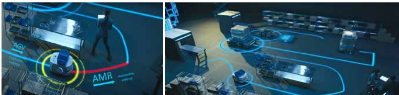
Slika 1 : Določitev poti z gibanjem v AGV-načinu in AMR-načinu
