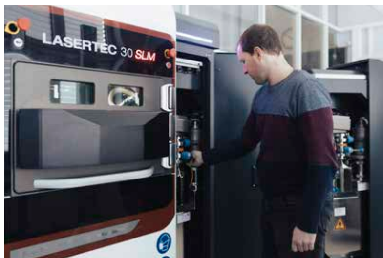
Slika 3 : Nadgradnja obstoječega sistema za 3D-tisk s selektivnim laserskim pretaljevanjem kovinskega prahu (foto: IFP, d. o. o.)
