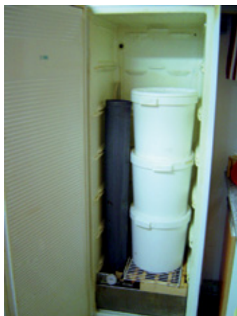
Komora za taljenje, v kateri kroži zrak skozi cevi z grelci
