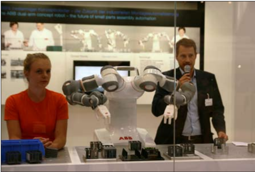
Slika 3. Zasnova dvorokega robota za namestitvev na ročno delovno mesto
