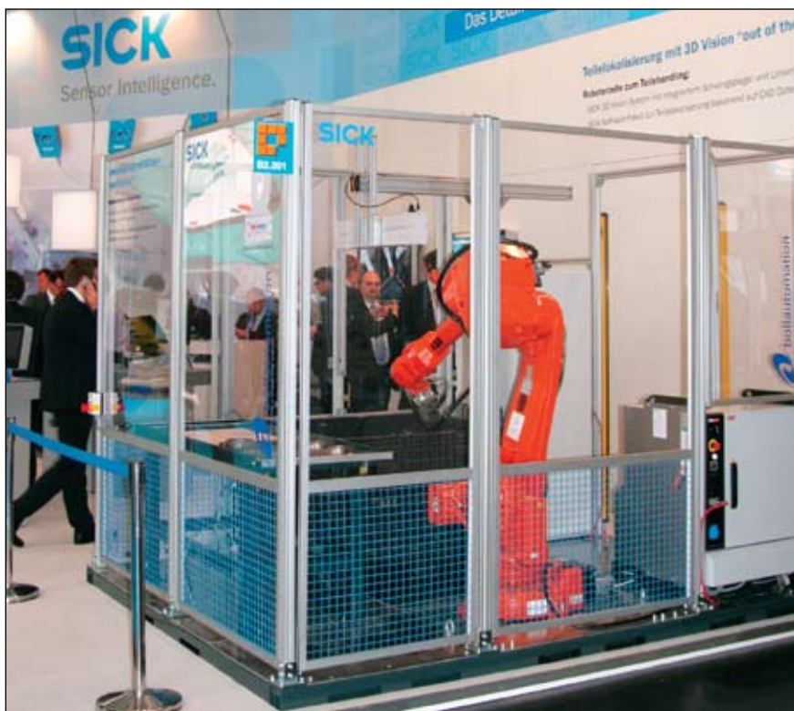
Slika 5. Robotizirano jemanje predmetov iz zaboja s pomočjo strojnega vida podjetja SICK
