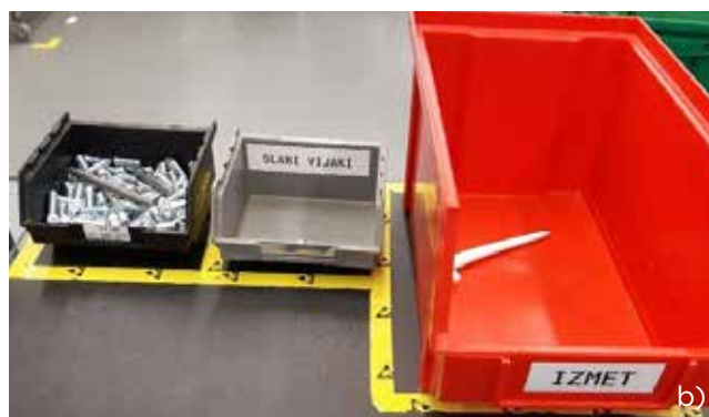
Slika 5 : Označbe za lokacijo tipkovnice na DM (a); Označbe za lokacije zabojčkov na DM(b).
