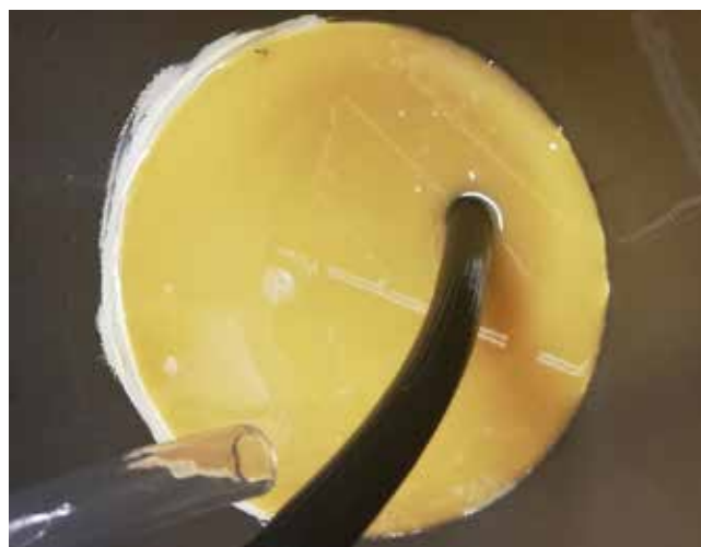
Slika 6 : Spenjena hidraulična kapljevina po zagonu dozirne črpalke.
