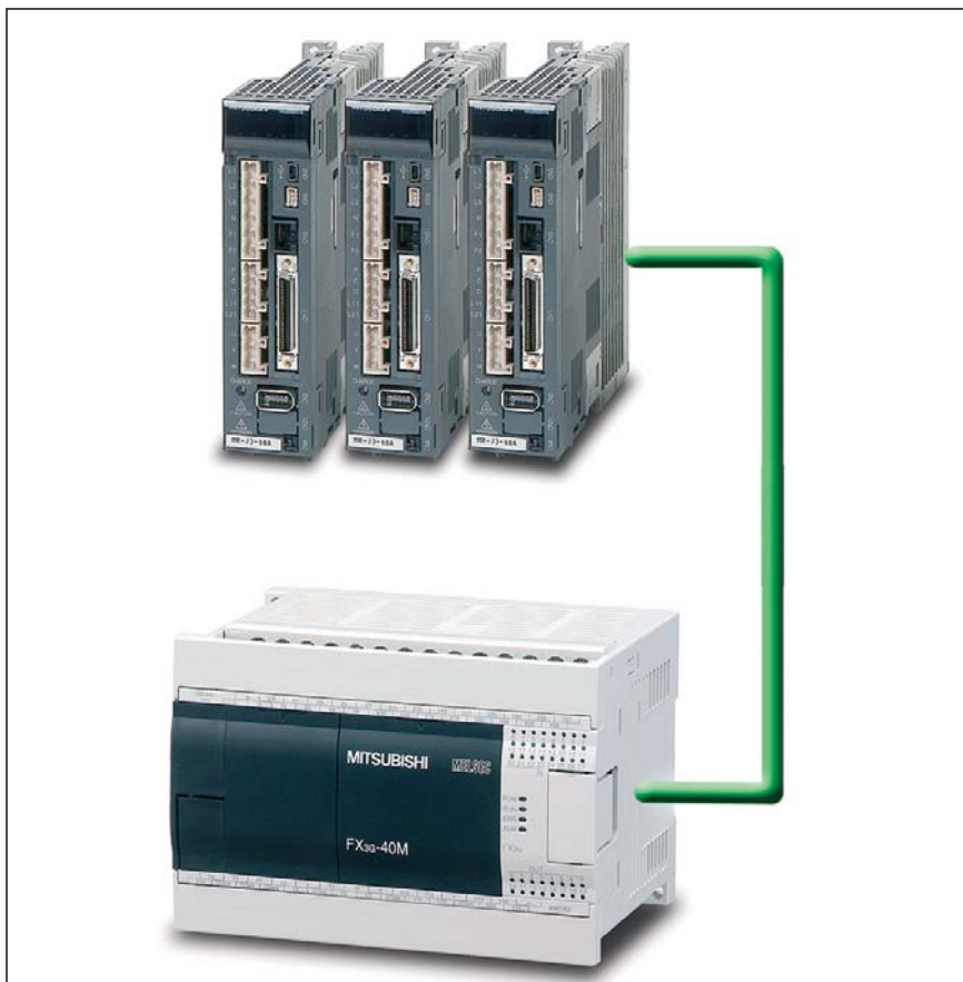
Slika 5. Uporaba krmilnika FX3G za neposredno krmiljenje do največ treh pozicionirnih osi, npr. Mitsubishijevih servosistemov MR-J3, brez vmesne opreme
