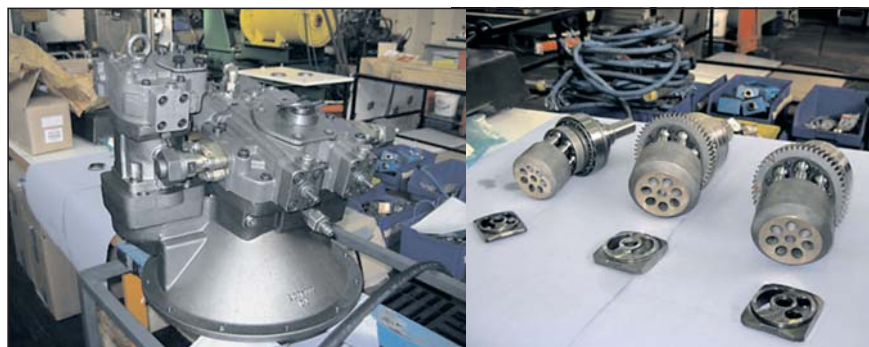
Slika 7. Določanje mazalnih lastnosti z aksialno batno črpalko A7/A8
