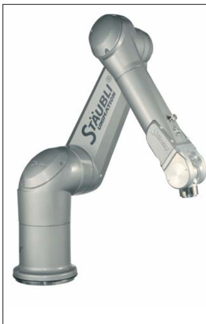
Robot Stäubli TX90 HE – verzija 2, namenjen delu v ekstremno vlažnih prostorih
