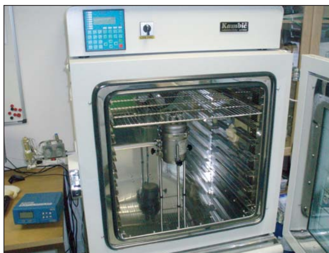
Slika 1. Postavitev opreme za umerjanje tlačnega spominškega zaznavala v razširjenem temperaturnem območju s pomočjo klimatske komore
