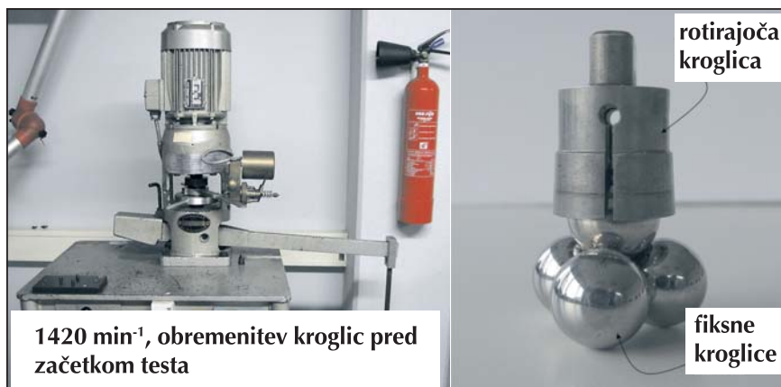
Slika 4. Določanje mazalnih lastnosti na štirikrogelnem aparatu
