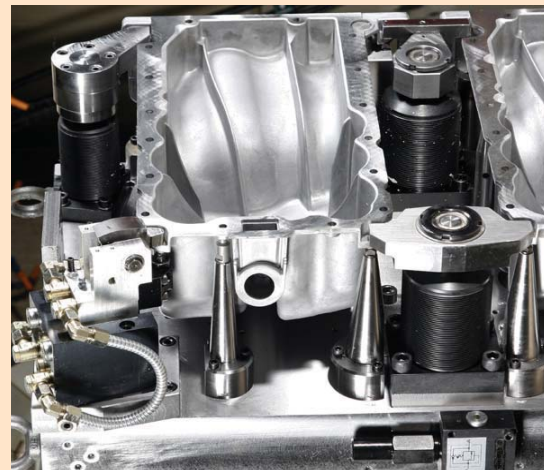
Prilagodljiva združitev: možnosti priključitev s cevnimi navoji ali pa z izvrtnimi kanali
