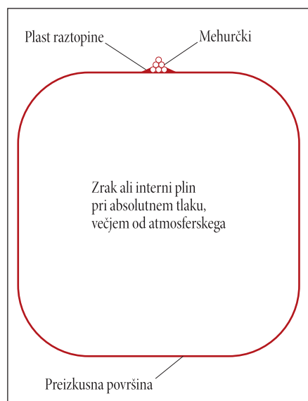
Slika 7: Preizkušavec pod nadtlakom slednega plina pri načinu preizkušanja z omočenjem površine (Vir: 4)
