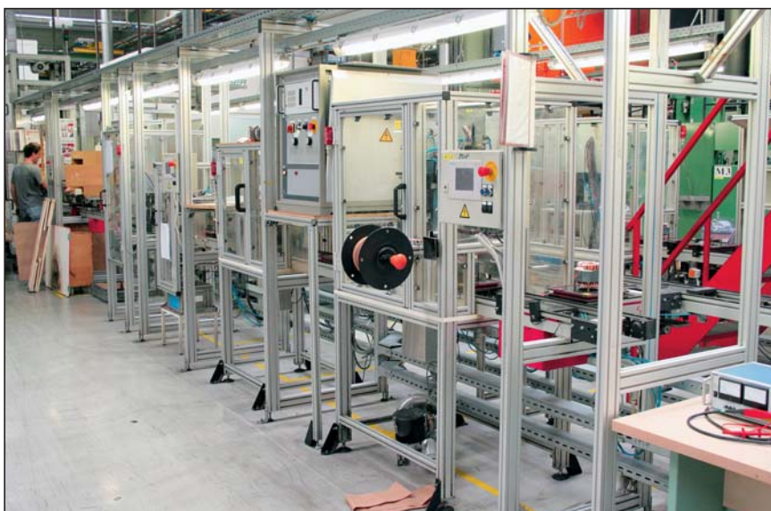
Del linije za izdelavo statorja za kompresor
