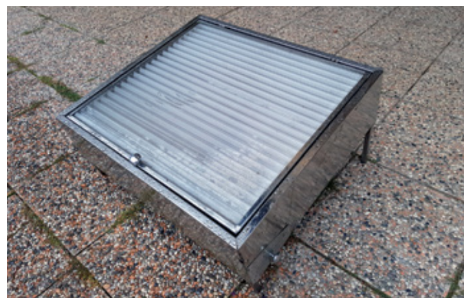
Preprost sončni talilnik, uporaben za taljenje manjših količin voska
