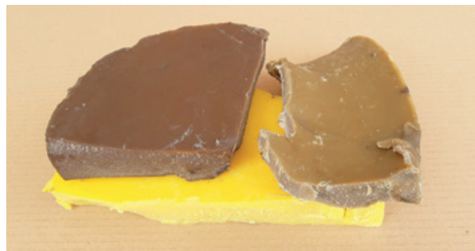
Vosek različnih barv, oddan v izdelavo satnic. Rjav vosek se je kuhal na previsoki temperaturi s premalo vode.
