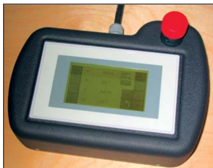
Slika 3. Upravljalna konzola robota z ekranom, občutljivim na dotik
