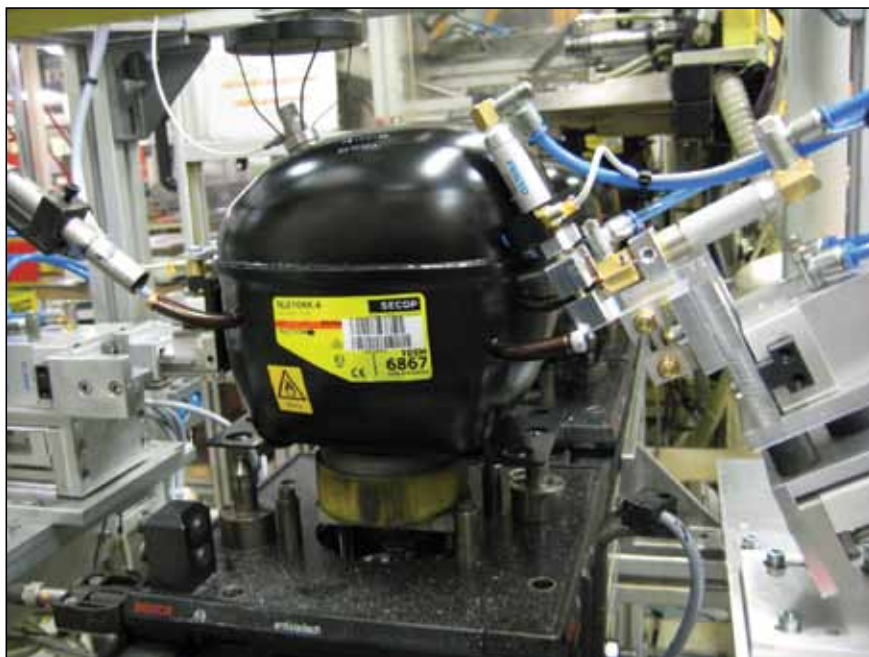
Slika 1. Diagnostični sistem za končno kontrolo kompresorja na proizvodni liniji
