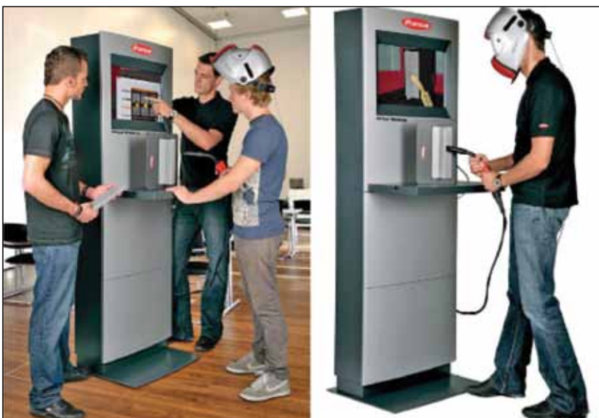
Slika 3. Naprava za virtualno učenje obločnega varjenja
