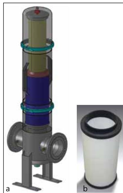
Vgraditev filtra – a in filtrirni vložek – b
