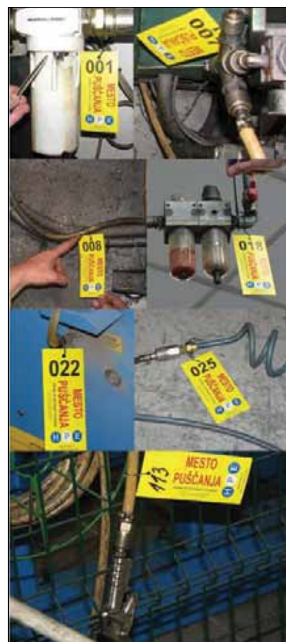
Odkrivanje puščanja zraka; označevanje mest puščanj z zaporedno številko
