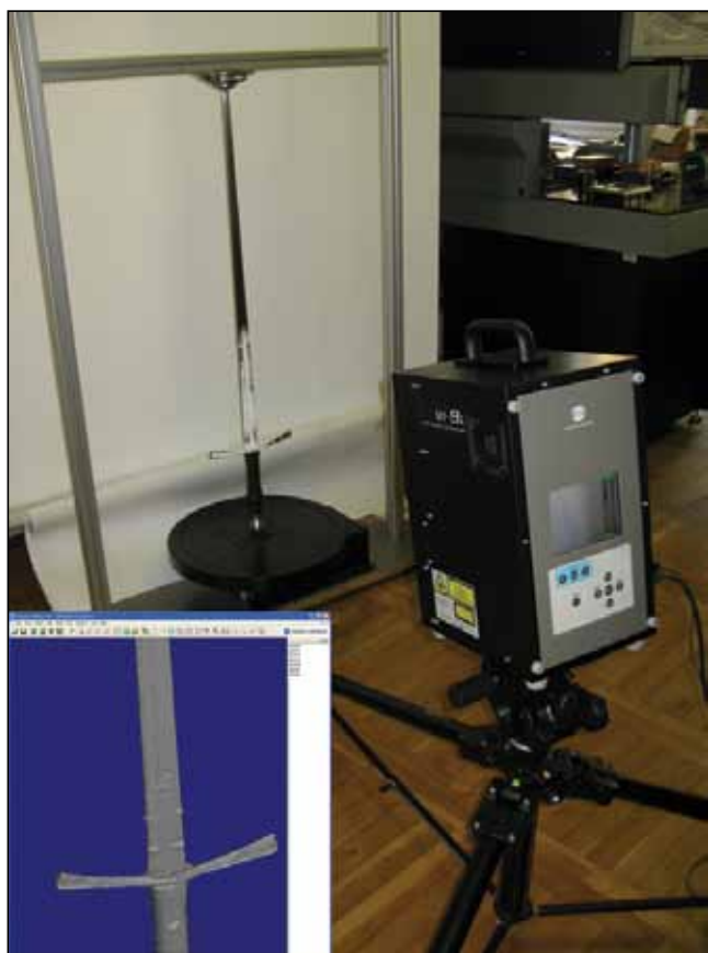
Slika 11. Vzvratno inženirstvo: brezdotično skeniranje srednjeveškega meča
