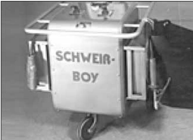
Slika 2. Eden izmed prvih varilnih transformatorjev z začetka petdesetih let, krmiljen brezstopenjsko z magnetnim jarmom
