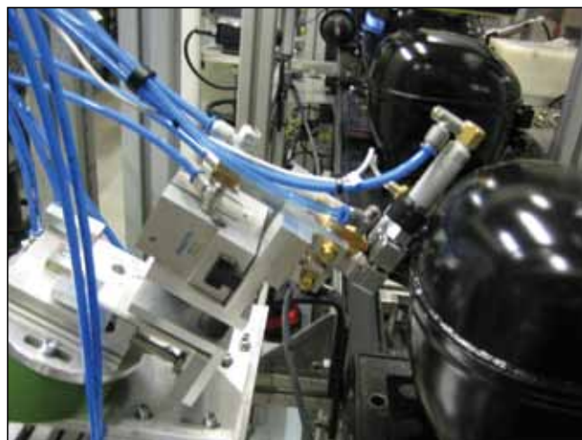
Slika 3. Protitlačni sistem za zagotavljanje ustrezne tlačne obremenitve kompresorja
