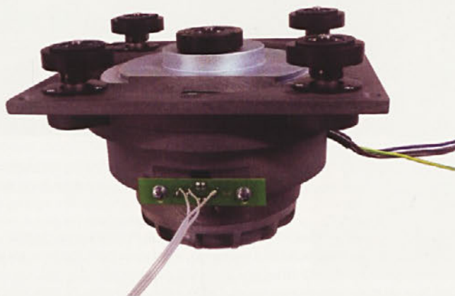
Lito ohišje z motorjem, zobniškim reduktorjem, optičnim čitalnikom in s štirimi ekscentričnimi oporami
