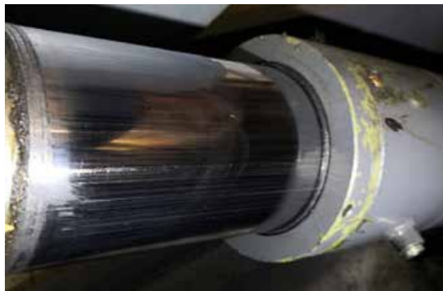
Slika 2 : Poškodovana trda prevleka na batnici hidravličnega valja
