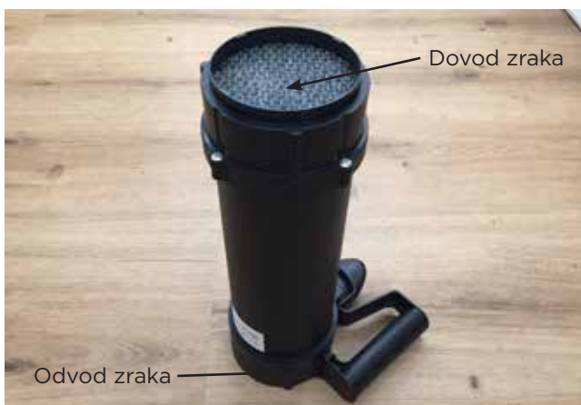
Slika 9 : Pripomoček za pretvorbo turbulentnega v laminarni tok
