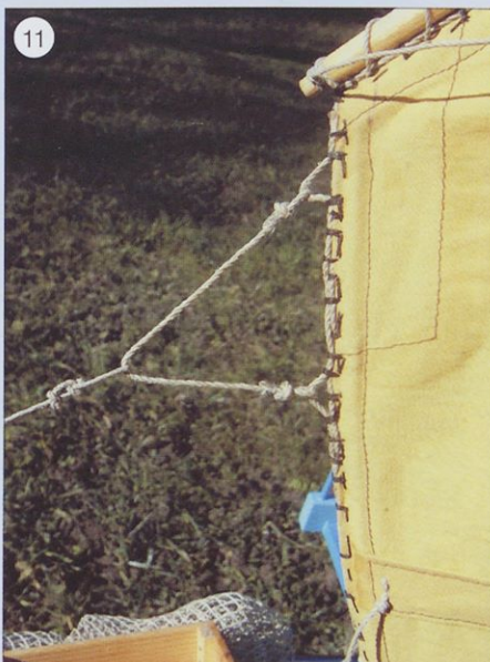
Detajl vezanja borine na sprednji ali premčni rob jadra. Z borino napenjamo jadro po premčnem robu.
