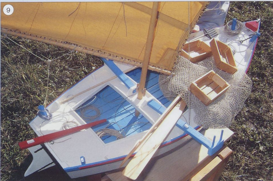
Detajl vezanja borine na sprednji ali premčni rob jadra. Z borino napenjamo jadro po premčnem robu.
