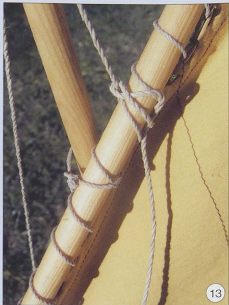
Detajl vozla na gindacu. Z gindacem se dviga jadro (vozel se nahaja približno na eni tretjini zgornjega penona). Na fotografiji vidimo tudi troco, vrh z zanko, s katero držimo zgornji penon in s tem jadro tesno k jamboru, ko je veter močnejši in je treba jadro krajšati, tj. spustiti in podvezati s kratkicami. Troca lahko objema gindac (detajl na skici jadra) ali pa zgornji penon, kot prikazuje slika.
