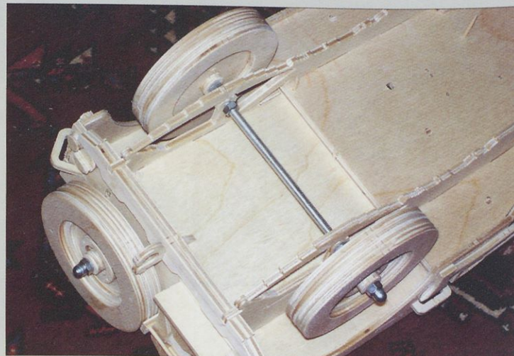
Slika 2. Najenostavnejša izvedba osi koles ni nujno najboljše, kar se tiče obrabe kosov. Za uporabo makete v igri priporočamo, da os koles uležajite s po tremi kosi medeninaste cevi, ki jih namestite skozi nosilce osi kot tudi skozi središče vsakega od koles. V našem primeru smo uporabili kar precej matic M5, da smo kolesa utrdili v pravilnem položaju.
