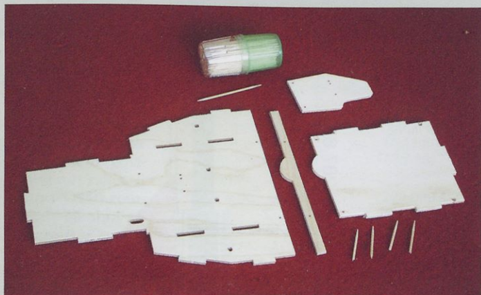
Slika 5. Gradnjo lahko začnemo z naborom prikazanih delov. Pri sestavljanju delov si pomagamo z zobotrepci. Med nameščanjem pazimo, da bo ovalna izvrtina, skozi katero poteka os volana, na pravi strani. Z lepljenjem ne hitimo. Uporabimo belo lepilo za les.
