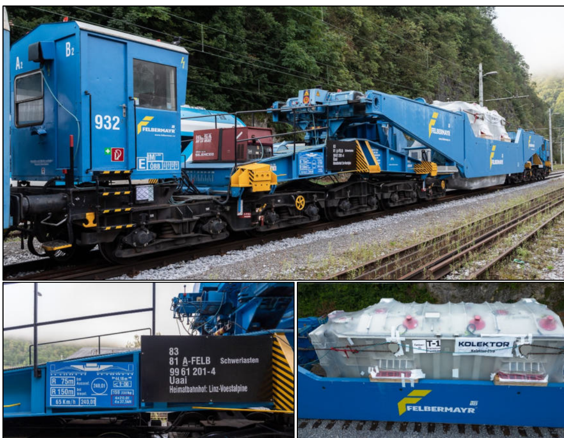
Transformator z maso 145 t na postanku v Zidanem Mostu, 1. september 2023. (Avtor: Bojan Dremelj)
