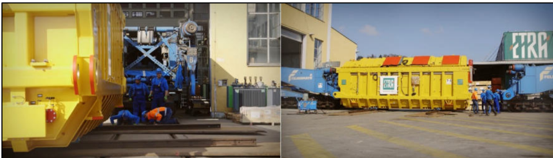
Postopek nakladanja transformatorja v Črnučah za način transporta B. (Vir: Kolektor ETRA)
