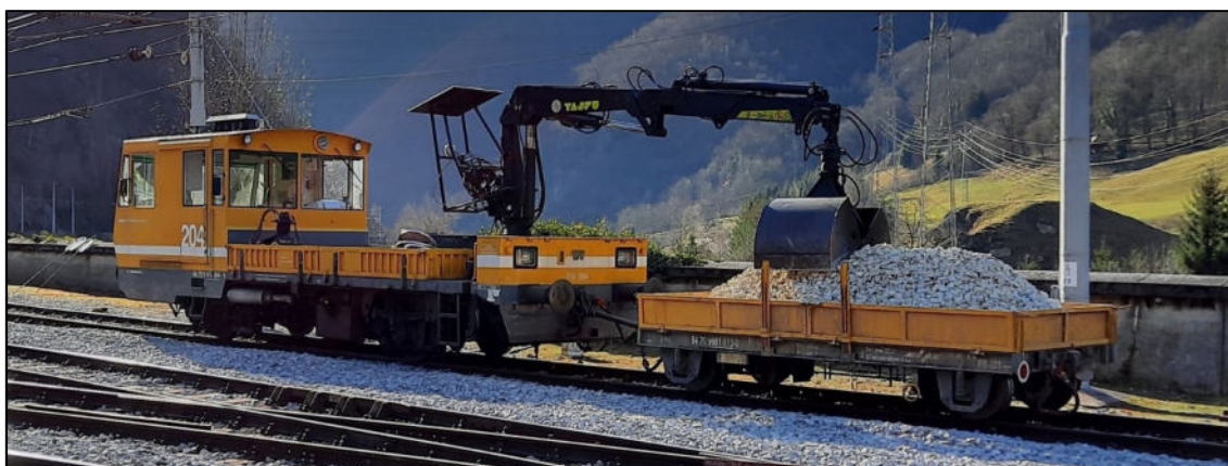
TMD SŽ 915-204 s tolčencem za kretnico št. 14, 5. februar 2023. (Avtor: mag. Klemen Ponikvar)
