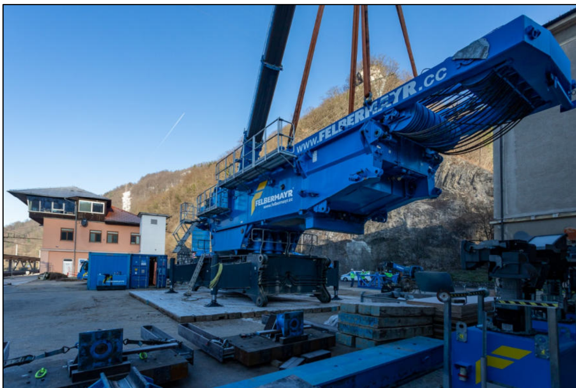
Šasija, rotator in osrednji del z okvirjem 'SA', 31. januar 2023. (Avtor: Bojan Dremelj)
