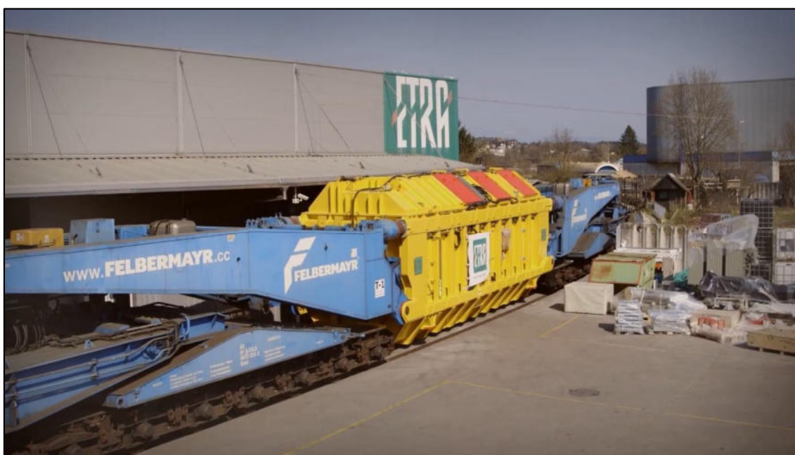
Transformator na industrijskem tiru ETRA v Črnučah (način transporta B). (Vir: Kolektor ETRA, https://www.youtube.com/watch?v=x5BjTrfkmuE )
