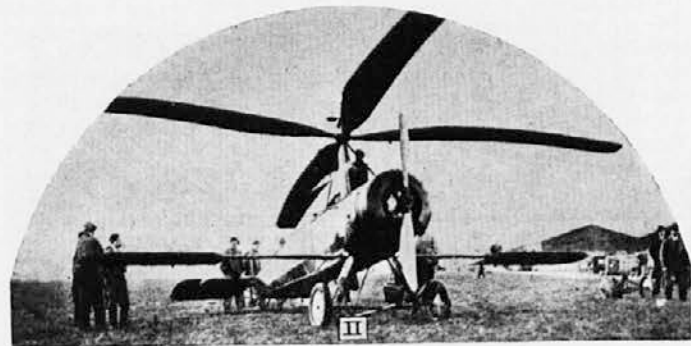
Autogiro z vertikalnim vijakom in pomožnimi krili za stabiliziranje. Nosilni vijak se vrti prosto, motor žene prednji propeler
