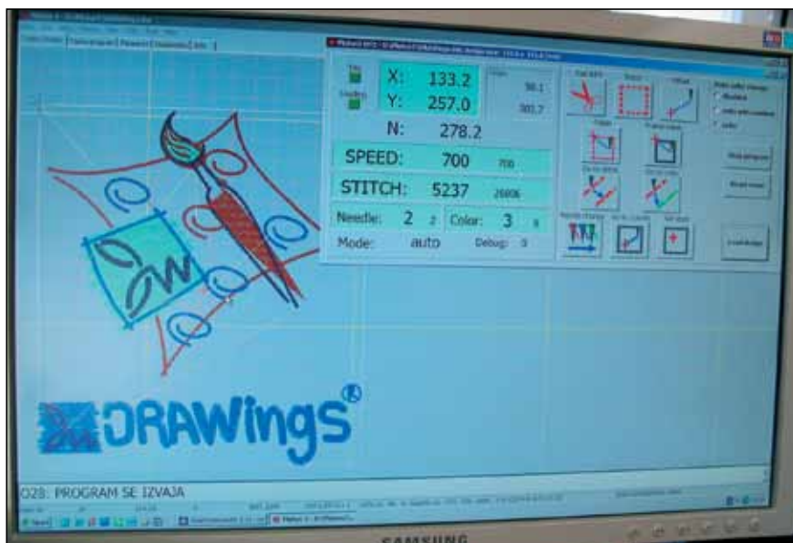
Slika 6. HMI-vmesnik stroja na PC-računalniku prikazuje vezilni design in trenutno stanje izdelave
