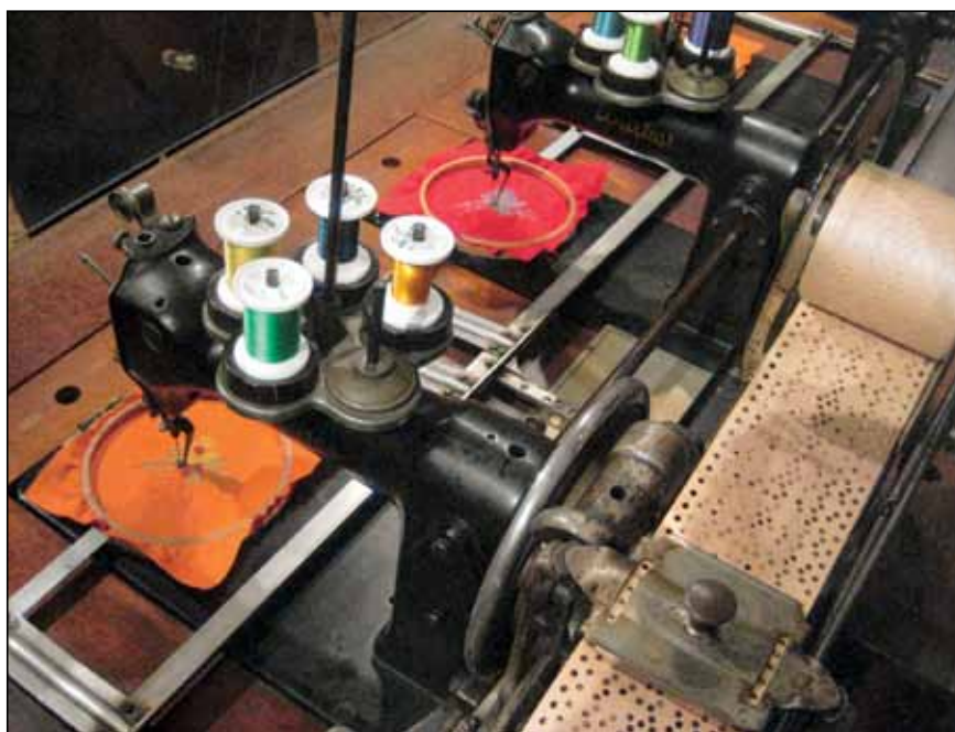
Slika 1. Avtomatični troglavi mehanski stroj za vezenje z luknjanim trakom iz leta 1928 (Würker GmbH, Dresden)
