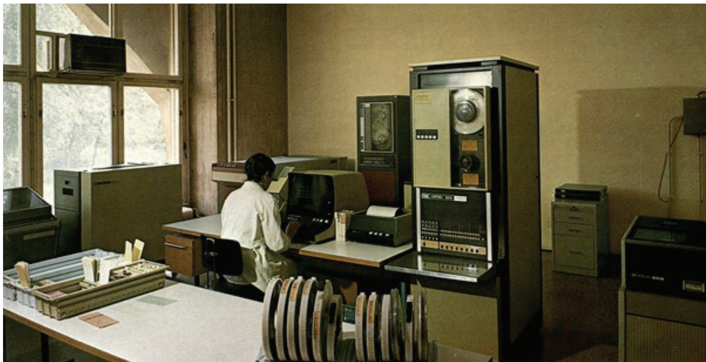
Slika 3. Računski center FAGG ca. 1981. Spredaj je računalnik CDC 1700 s tiskalnikom (pri oknu) in diskovnim pogonom (skrajno desno), zadaj v kotu risalnik Versatec A0 s pripadajočim tračnim pogonom.
