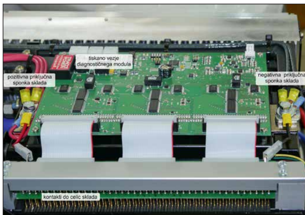
Slika 1. Električno vezje diagnostičnega modula FCVM 2404, priklučeno na sklad 80 gorivnih celic PEM
