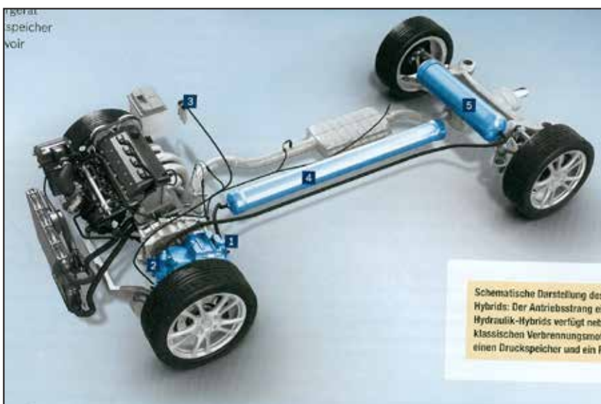
Slika Hidravlični hibridi: 1 – hidravlični motor, 2 – hidravlična črpalka, 3 – krmilje, 4 – hidravlični akumulator, 5 – rezervoar
