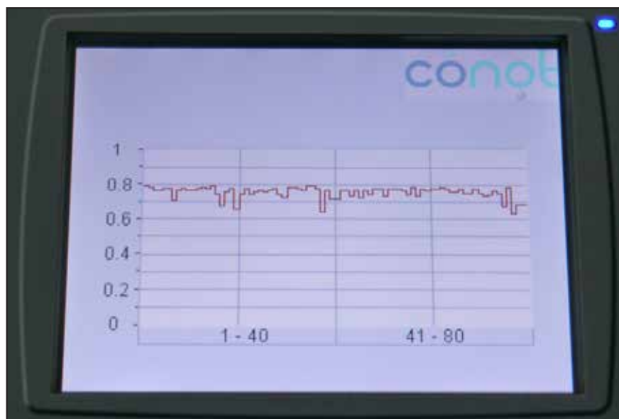
Slika 2. Prikaz napetostnega profila večjega sklada gorivnih celic PEM na HMI-terminalu
