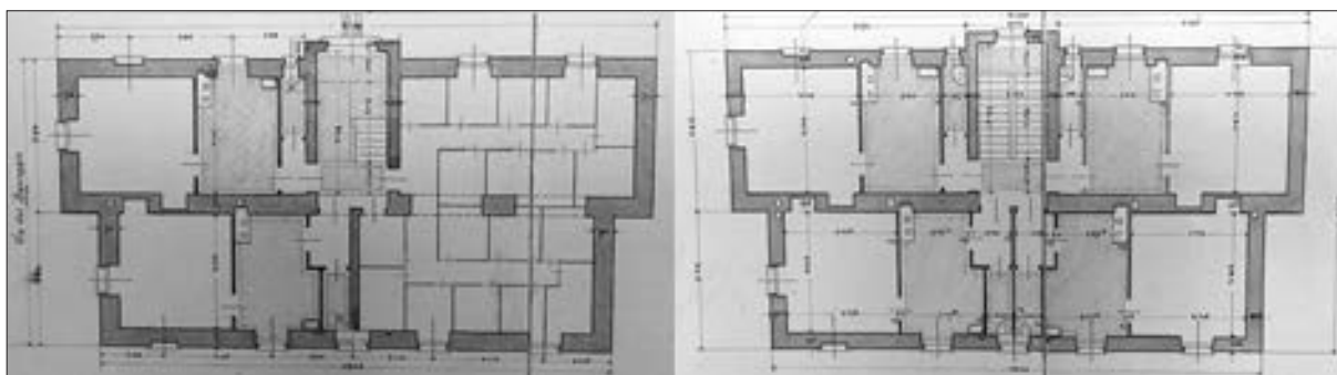
Tloris pritličja in kleti (levo) ter zgornjih nadstropij (desno) večnadstropne stavbe ob via Baseggio (G. B. Finetti, 1906) (ATD – Ts, načrt št. 8809).
