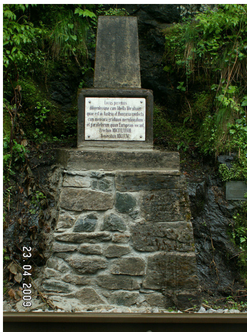
Slika 3: Normalni reper nivelmanske mreže 1. reda, N1-V-FR1049.
