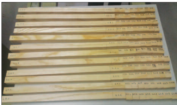
Slika 1. Priprava preizkušancev velikega pajesena za merjenje izbranih fizikalnih in mehanskih lastnosti.
