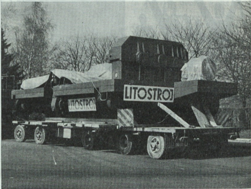
Žerjav za Krško je pripravljen za prevoz — širina 4,80 m, dolžina 7,20 m in teža 28 ton
