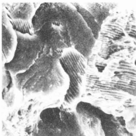
Posnetek inter- in transkristalnega preloma jekla s perlino strukturo, P 10000x
