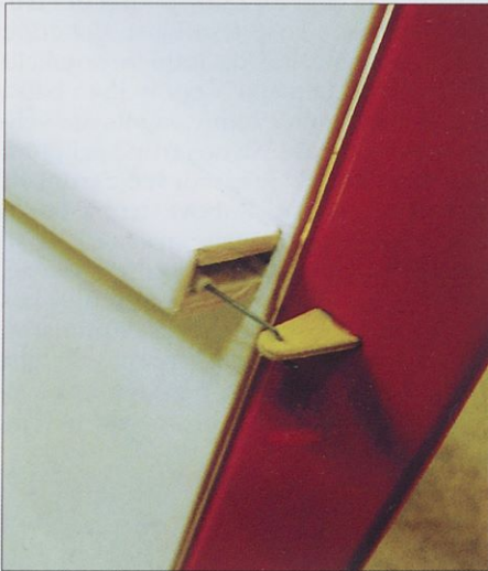
Izhod komande višine iz zadnje odprtine v trupu
