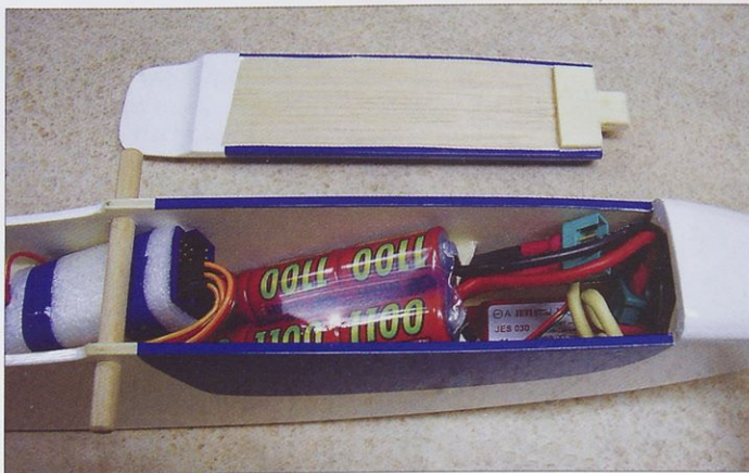
Akumulator leži poševno na mizici, da med trkom odleti skozi pokrov kabine in ne poškoduje motorja ter krmilnika vrtljajev.
