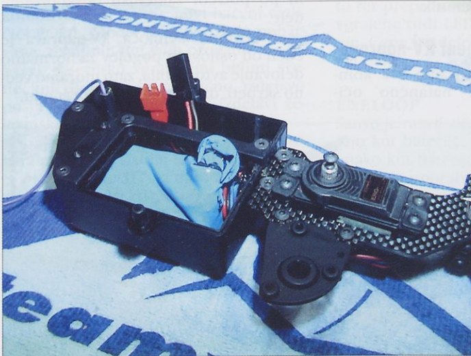
Sprejemnik vodotesno zaščitimo z gumijastim balonom.
