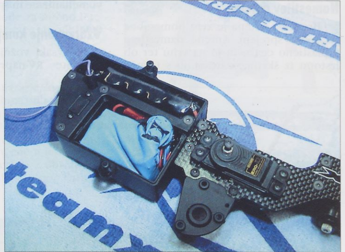
Akumulator, vgrajen v škatlico za RV-napravo
