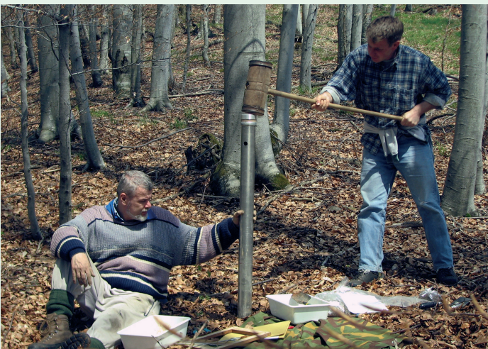
Slika 7: Odvzem volumenskih vzorcev mineralnega dela tal s cevasto sondo iz vnaprej določenih globin (0 do 5 cm, 5 do 10 cm, 10 do 20 cm, 20 do 40 cm, 40 do 60 cm, 60 do 80 cm).
