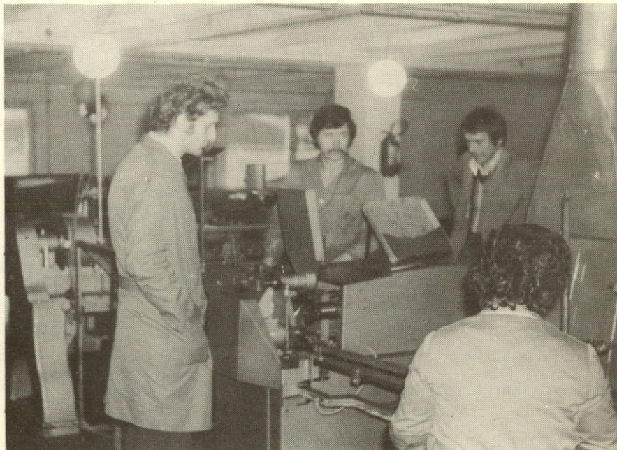
V petek 23. septembra so v Šentvidu dokončno ukinili zadnja ročna dela na formiranju celic R 10, ko je začel delovati v Zmaju izdelan stroj za tehnologijo paperlined.
