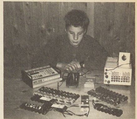
Slika 1: Pribor in celice na testu: na levi strani je superpolnilnik MFC 535, v sredini AKKU-TESTER in DVM, na desni pa TIMOV hitri polnilnik iz prejšnje številke. Spredaj so baterije: levo so trije kompleti izbranih baterij SANYO SCE in SCRC, na sredini so baterije PANASONIC RED AMP PLUS, na desni pa zopet SANYO 1700 SCRC in 1400 SCR TNT. Povsem spredaj desno so baterije VARTA HI CAP, ki pa se niso kaj prida obnesle.
