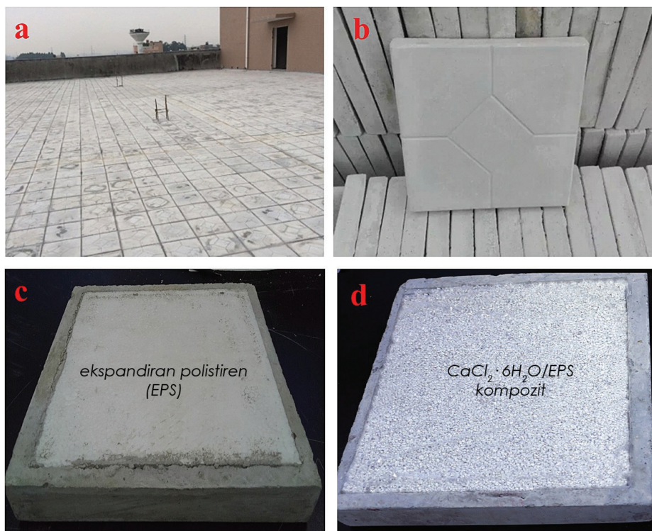
Slika 12 • Uporaba betonskih plošč na strehi (a), betonski zgornji del plošče (b), običajna betonska plošča z ekspandiranim polistirenom (c) in betonska plošča s \text{CaCl}_2 \cdot 6\text{H}_2\text{O}/\text{EPS} kompozitom (d) (povzeto po (Fu, 2017)).
