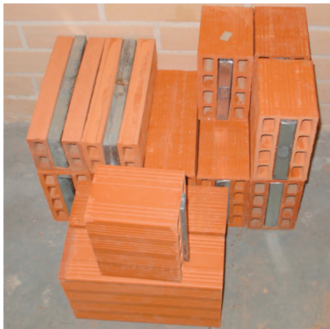
Slika 15 • Opečni zidaki z vstavljenimi makrokapsulami PCM (povzeto po (Silva, 2012)).
