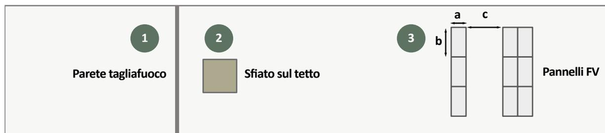
**Figura 8:** Vista dall'alto di un tetto con (1) parete tagliafuoco, (2) sfiato sul tetto e (3) pannelli FV. Lo sfiato sul tetto deve inoltre rispettare gli standard nazionali per quanto riguarda la distanza dalla parete tagliafuoco.
