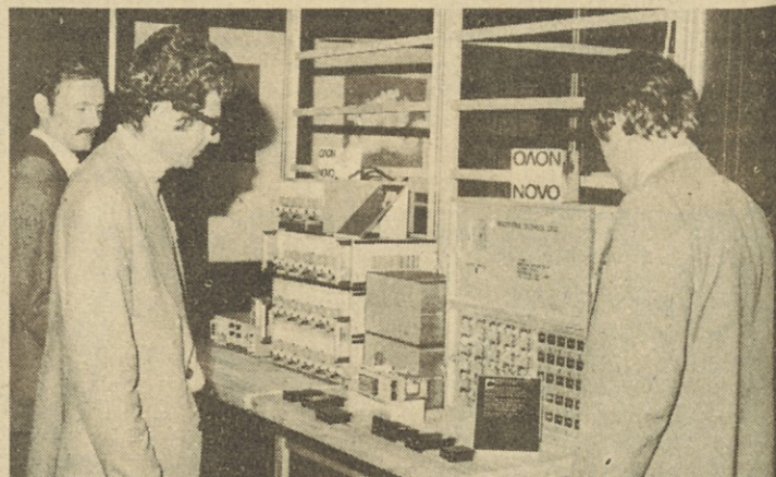
JUBILEJNI 25. SEJEM ELEKTRONIKE — registrirnik delovnega časa na desni, na levi pa polprevodniški stabilizirani usmernik v modulni izvedbi zvezno regulacijo napetosti in toka
