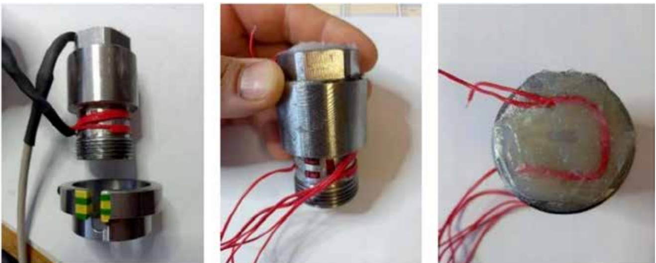
Slika 8 : Modificiran čep M33x2, opremljen z merilnimi lističi (Vir: Po-clain Hydraulics)
