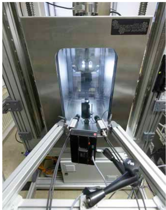
Slika 1 : Temperaturna komora za večkamerni dvostranski merilni sistem (Foto: IFP, d. o. o.)
