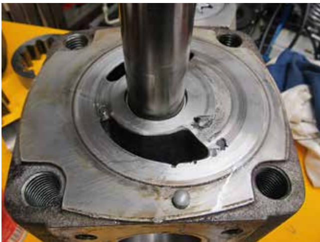
Slika 2 : Primer obrabljene zobniške črpalke z notranjim ozobjem
