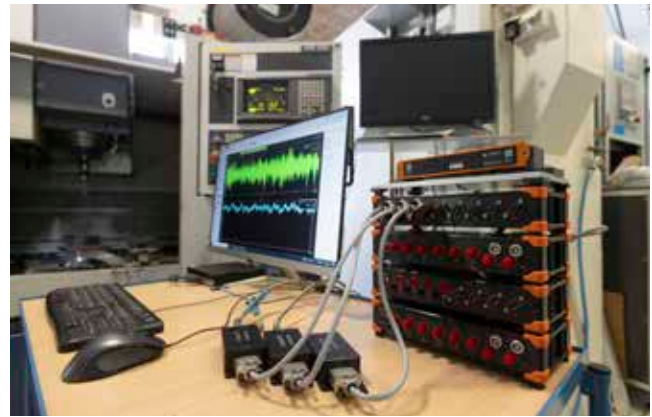
Slika 3 : Visoko kvalitetni merilni instrumentalni sistem za zajem podatkov, testiranje in kontrolo fizičnih fenomenov proizvodnih procesov (Foto: IFP, d. o. o.)
