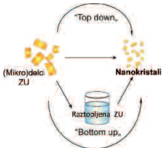
Slika 1: Shema izdelave nanokristalov: (i) z združevanjem osnovnih gradnikov (molekul učinkovine) v delce nanometrskih velikosti (tehnologije bottom up) in (ii) z zmanjševanjem velikosti delcev učinkovine (tehnologije top down); ZU - zdravilna učinkovina.
