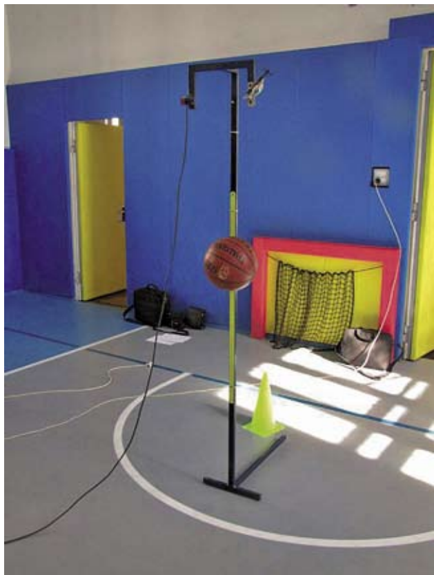
Slika 2: Naprava za preiskavo navpičnega odboja žoge in prikaz značilne meritve.
