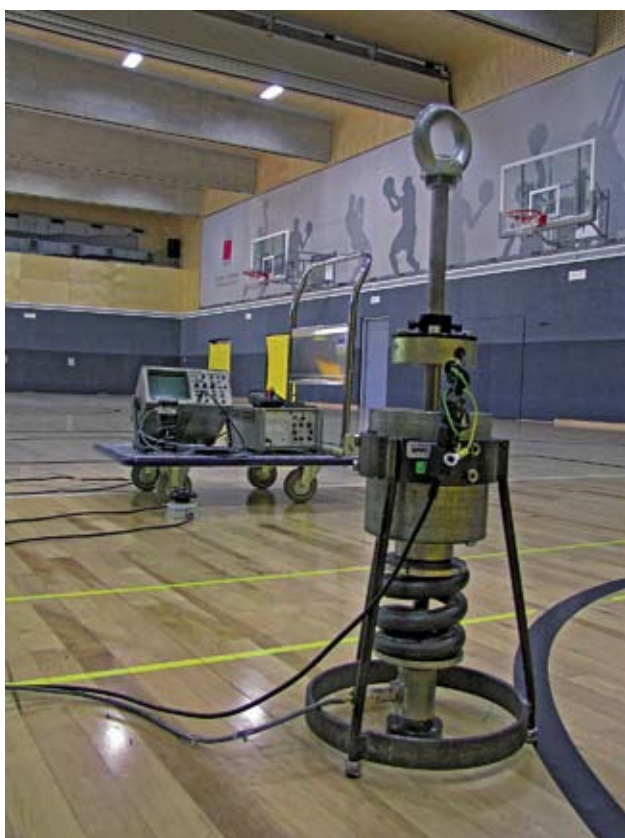
Slika 1: Naprava za meritev ublažitve udarca (umetni športnik).
