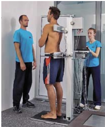
Slika 1: Meritve jakosti mišic trupa. Na levi strani preiskovanec izvaja upogib v kolku in v statičnih pogojih pritiska z rameni proti senzorju sile. Na desni strani se izvaja stranski upogib. Pri vseh nalogah je preiskovanec fiksiran preko bokov.
