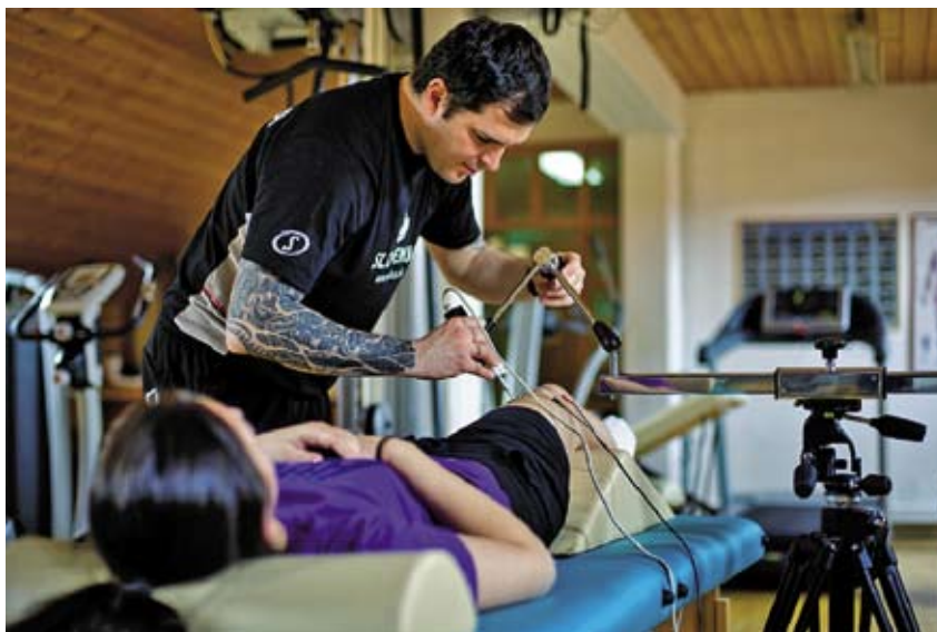
Slika 5: Aparatura TMG za merjenje kontraktilnih lastnosti mišic.
