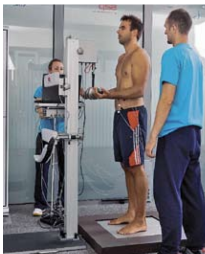
Slika 3: Nenadna obremenitev za vrednotenje refleksnih mišičnih odzivov se izvede preko rok, ki ima preiskovanec dlani obrnjene navzgor s pokrčenimi komolci. Sprostilni mehanizem spusti ročko z utežmi, ki jo mora preiskovanec ujeti.
