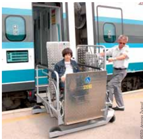
Mobilno dvigalo za lažje vstopanje potnikov z omejeno gibalno sposobnostjo na vlake in z njih.
