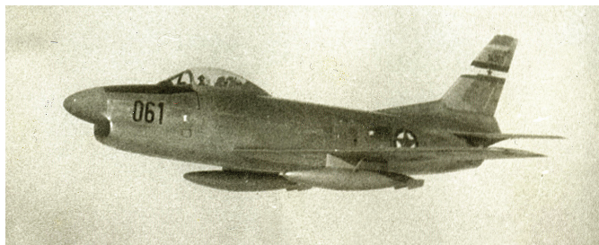
F-86D s serijsko številko 14061 v zraku. Letalo ima nepobarvan aerodinamični pokrov radarja. Satasta struktura pokrova je bila svetlo oker barve. Za barvanje tega pokrova je bila potrebna posebna barva, ki ni ovirala prehoda radijskih valov skozi pokrov. (Foto: arhiv Marjana Žerjala)
