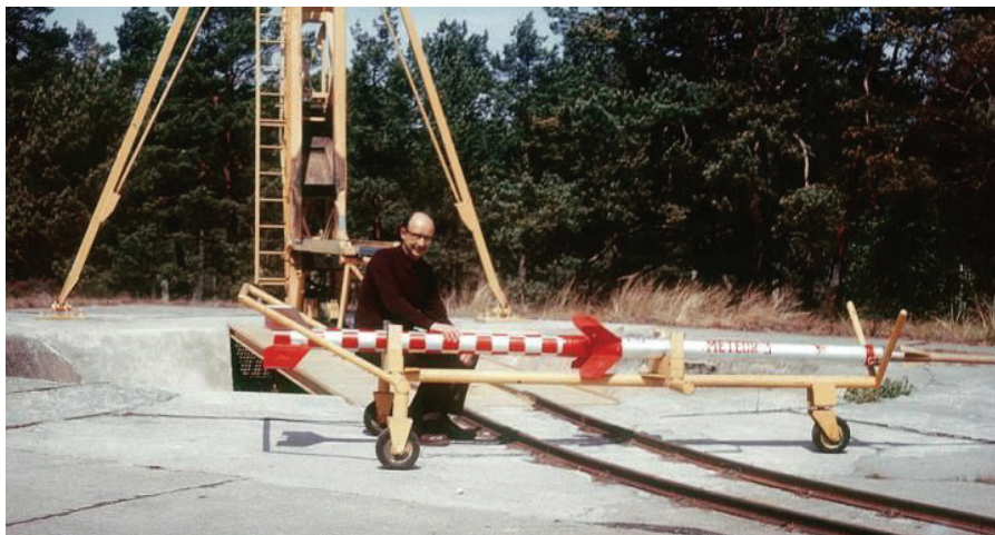
Priprave na izstrelitev dvostopenjske meteorološke rakete meteor 3. V ozadju je lansirna naprava. (Vir: Instytut Lotnictwa)
