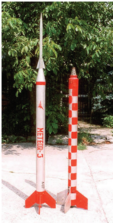
Ločeni stopnji rakete meteor 3 (Vir: internet)
