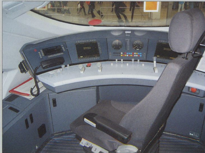
Preprosta in udobna notranjost strojevojske kabine hitrega potniškega vlaka ICE 3, ki je s predelno steno ločena od potniškega prostora.
