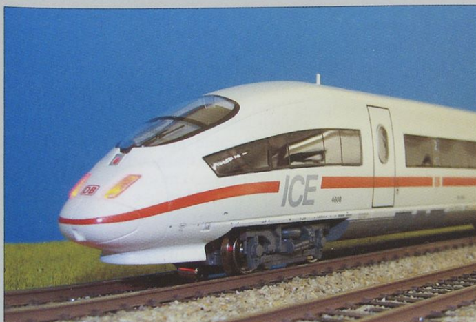
Prvi in zadnji vagon v garnituri sta zaključena s strojevodsko kabino aerodinamične oblike. Za osvetlitev žarometov so vgrajene belo-rdeče svetleče diode, njihovo delovanje pa je odvisno od smeri vožnje.
