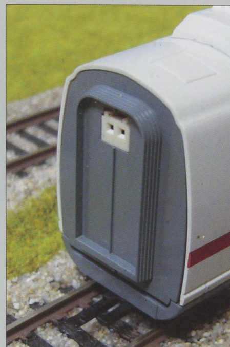
Prvi pogonski in drugi vagon v garnituri s funkcionalnim tokovnim odjemnikom sta med seboj povezana prek vtičnice. Za spajanje vagonov so vgrajene posebne kratke kulisno vodene spenjače.
