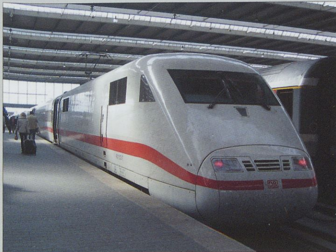
Pogonska glava (lokomotiva) garniture hitrega potniškega vlaka Inter City Express prve generacije (ICE 1) z oznako 401
