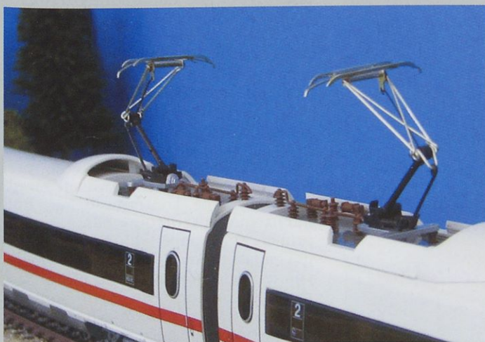
Na Mehanovem modelu ICE 3/406 je vgrajenih šest kovinskih tokovnih odjemnikov. Tokovni odjemnik na drugem vagonu ima funkcijo napajanja modela z elektriko iz zgornjega električnega voda.
